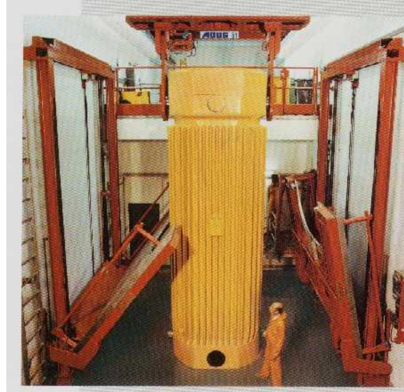
Cask dual purpose (trasporto-stoccaggio per HLW e combustibile irraggiato) (Gorleben, Germania)
